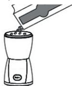
4. Установите крышку на моторном блоке. Поверните крышку по часовой стрелке до упора. Убедитесь в том, что крышка надежно зафиксирована.
