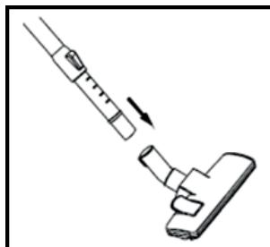
Эта насадка имеет два рабочих положения. При очистке твердых поверхностей (паркетных полов, плитки и т. п.) щетина щетки должна быть выдвинута.
