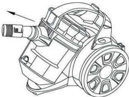
Соедините удлинительную трубу с рукояткой, удлинительные трубы между собой, и трубу со щеткой для пола, как показано на рисунке.
