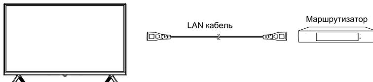
Подключите LAN кабель со штекером RJ-45 к разъему LAN на задней стороне телевизора. Это необходимо для работы SMART режима ТВ в режиме проводной интернет-сети.
