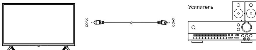
Только для ЦТВ или HDMI источника сигнала. Подключите коаксиальный вход внешней аудиосистемы к соответствующему выходу телевизора. Коаксиальный выход телевизора обеспечит вам наиболее качественную передачу звука на внешнюю аудиосистему без искажений.
