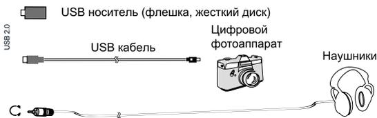
Разъем для подключения USB-устройства телевизора становится активным только в режиме USB.
